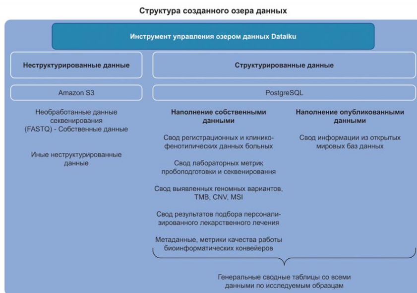
Рисунок 3 — Структура и элементы наполнения озера данных в рамках фармакогенной платформы. CNV (англ. copy number variation) – вариация числа копий, MSI (англ. microsatellite instability) – микросателлитная нестабильность, TMB (англ. tumor mutational burden) – опухолевая мутационная нагрузка
