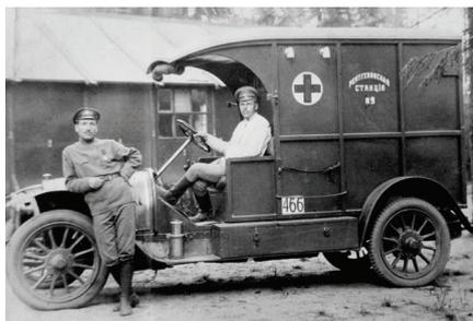
*Передвижная автономная рентгеновская установка на базе автомобиля*
