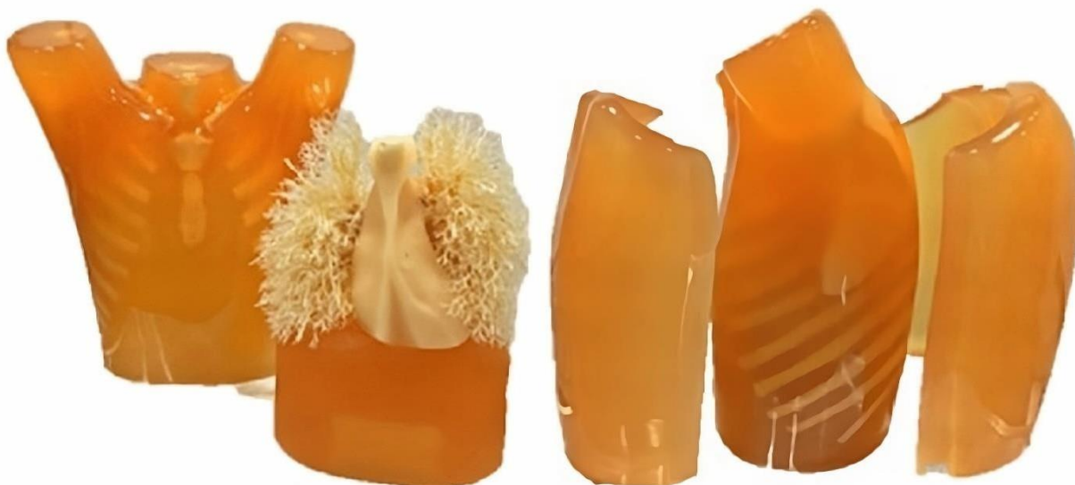
Рисунок 10. Фотография использованного антропоморфного модельного объекта PH-1 Multipurpose Chest Phantom N1 (Kyotokagaku, Япония) со специальными утолщающими пластинами.
