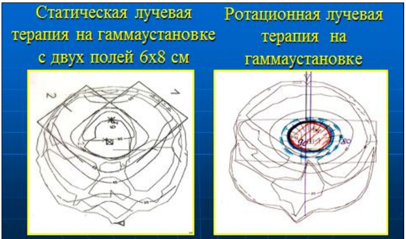
Рисунок 6 – Схема распределения дозы при использовании двухплоскостного планирования и облучении на гаммаустановке с двух боковых полей и в режиме ротации.
