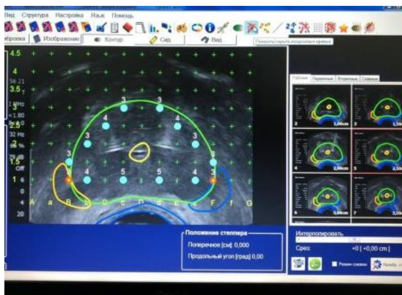
Рисунок 11 – Дозиметрическое оконтуривание области расположения СНП при брахитерапии I-125 (этап планирования)
